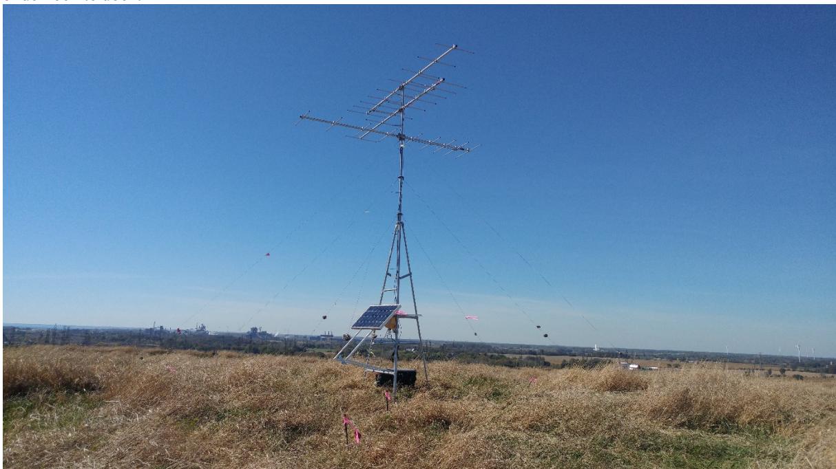
Motus ontvangststation op een kale heuvel geplaatst. De mast heeft 3 directionele antennes (type ‘oude televisieantenne’).
